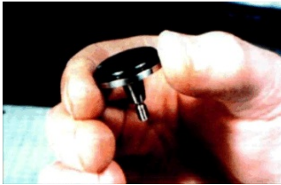
Рис.8. Образец вяжущего толщиной 1 мм и диаметром 25 мм для испытания на сдвиг при циклическом кручении с помощью динамического сдвигового реометра (DSR)
