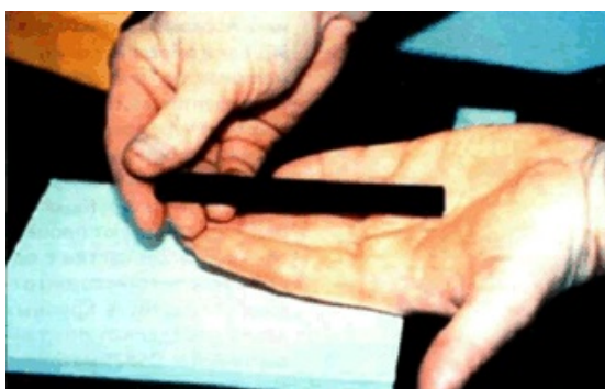
Рис.9. Образец вяжущего в виде балки с размерами 125x12,5x6,25 мм для испытания на изгиб при низкой температуре
